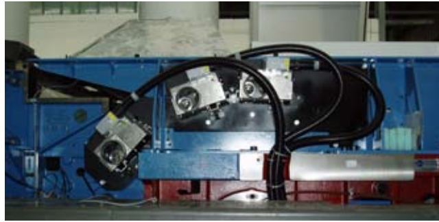
Secado IR - aire caliente después de la 2ª unidad de barnizado de una KBA-205. Generación de aire, con energía eficiente en el elemento de secado: Detrás del tubo de suministro de aire (aquí todavía abierto), se puede apreciar una reactancia de calor (4KW Sistema Grafix).
