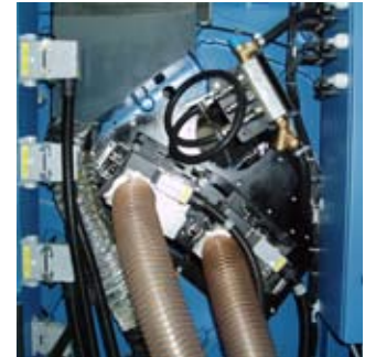
Misma posición de montaje, sistema de secado diferente: En este caso, dos secadores de IR - aire caliente están montados en la subida de hoja para el secado convencional.
